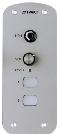
Рисунок 2.1 – Панель ТР-325, вид сверху
