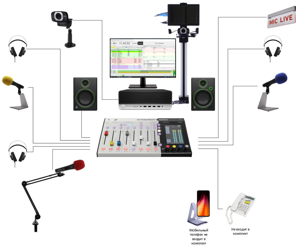
Рисунок 2 Структурная схема комплекса Synergy MINI Visual Radio
