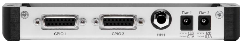
Рисунок 2.3 – Корпус TP-327, вид спереди.
